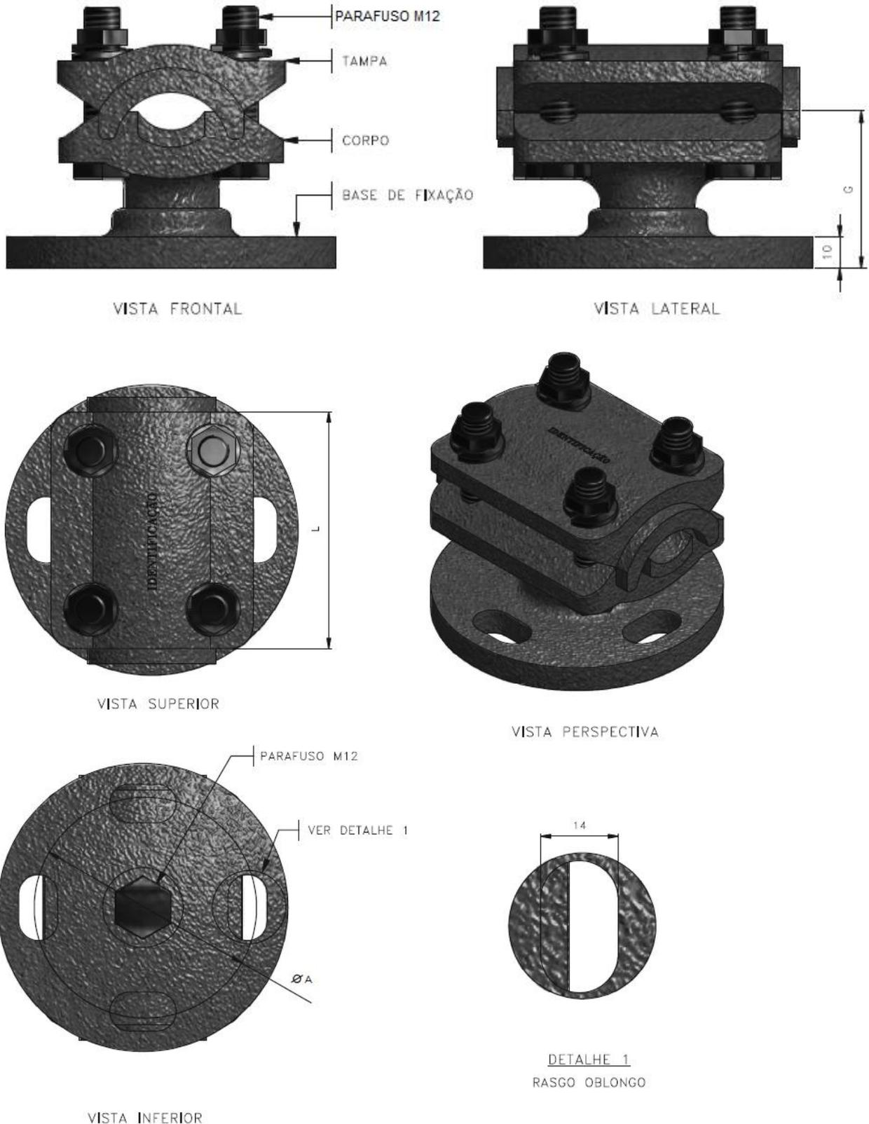
Figura 1 – Conector Suporte para Cabo de Alumínio
